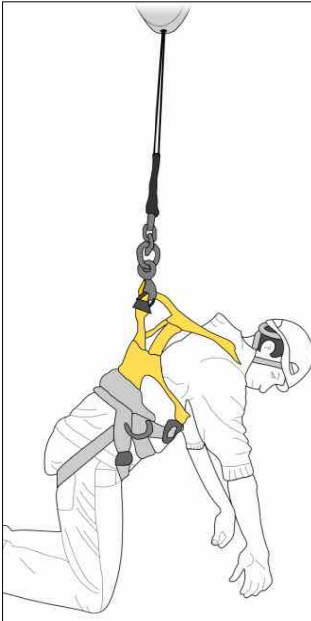
Seil nicht zugänglich - keine Entlastung möglich
