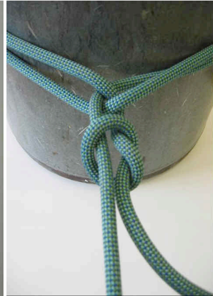
Mastwurf zusätzlich mit Kreuzschlag abgesichert
