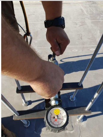
Vorgehen bei der Prüfung bestehender Anschlagseinrichtungen durch einen Sachkundigen (Auszug aus Norm EN 795)
