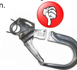
Bild 10: unsachgemäßer Gebrauch eines Rohrhakens (z.B. Aluminium) kann zum Bruch / Absturz führen
