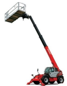
Bild 3: Multifunktionsgerät mit schwenkbarem Arbeitskorb und geeigneten Zugangstüren
