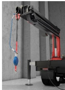
Bild 5: Redundante Sicherung am Krantragwerk
